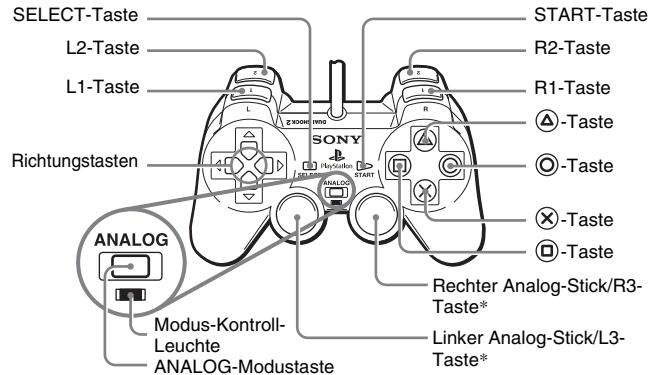
\* Der linke und der rechte Analog-Stick bzw. die L3- und die R3-Taste funktionieren nur im Analogmodus (Kontroll-Leuchte: rot).
